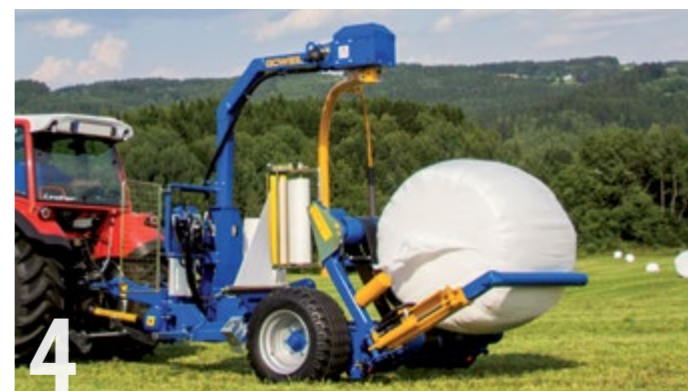
4. Odložení balíku se provádí šetrně dozadu.
