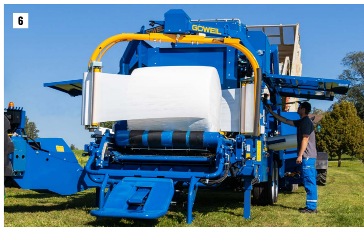
Balík je perfektně ovinut a potom odložen
