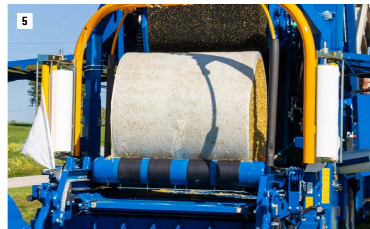
Balík je vyzvednut pojízdným ovíjecím stolem
