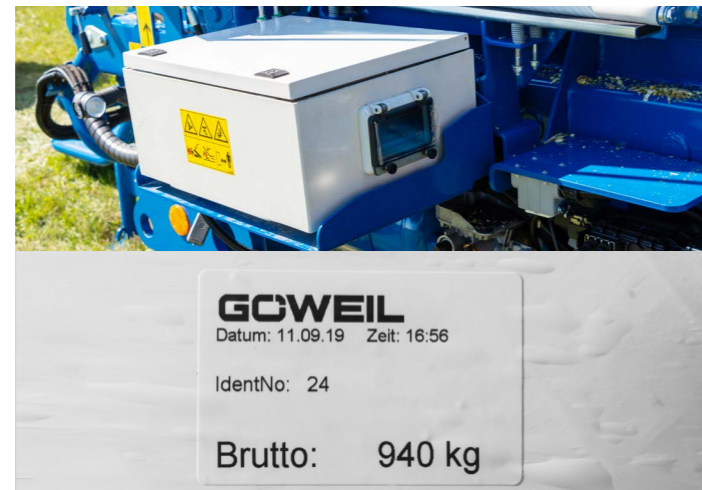
Tiskárna etiket (nahore) a samolepící etiketa na kulatém balíku (dole)
