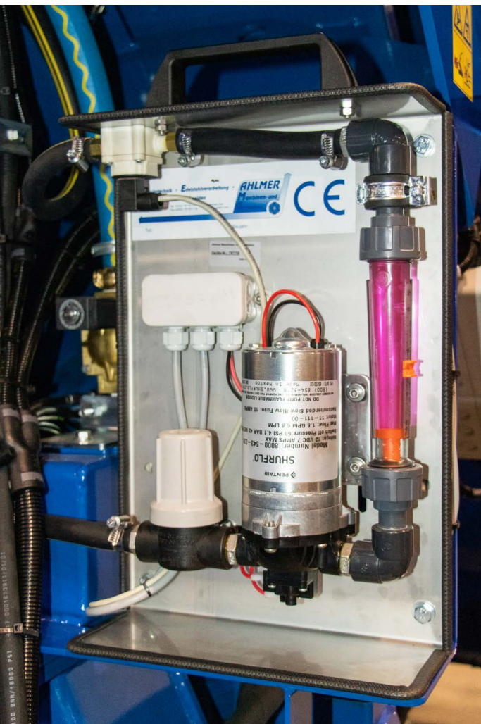
Čerpadlo s filtrem, průzor a elektronický měřič průtoku
