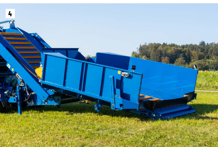
4 Odklopení stěn šikmého dopravníku a podavače
