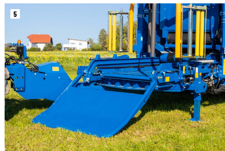
5 Sklopení balíkové rampy
