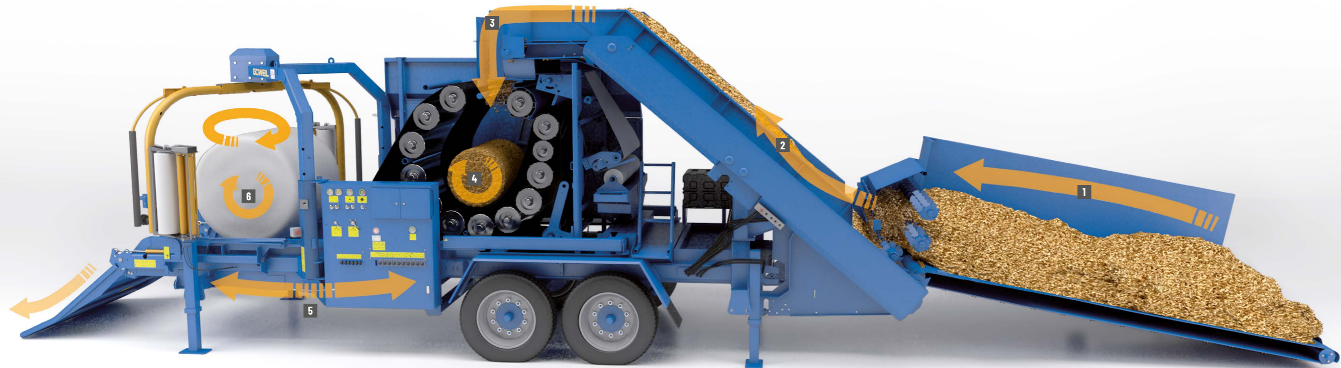
Materiál se odkládá na prostorný podavač
