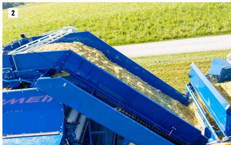
Perfektně dávkovaný materiál se dostává z podavače na šikmý dopravník
