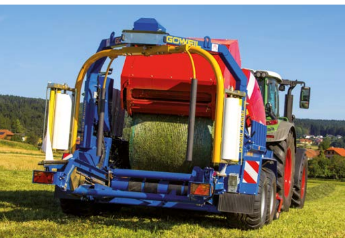
Balík se předá z lisu na pojízdny ovíjecí stůl.
