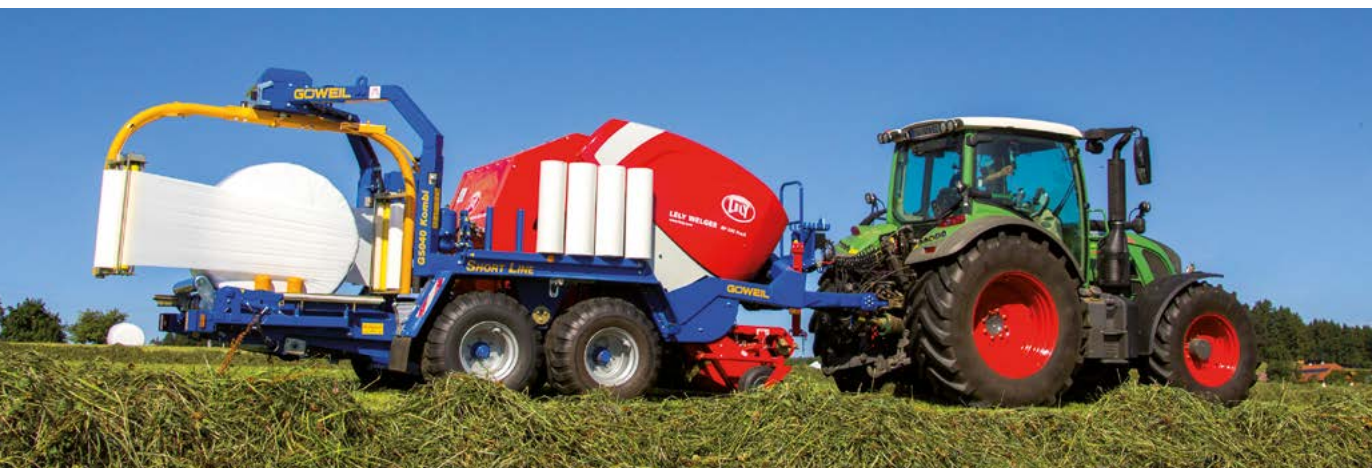
S dvojitým ovíjecím ramenem je balík ovinut během minimální doby.
