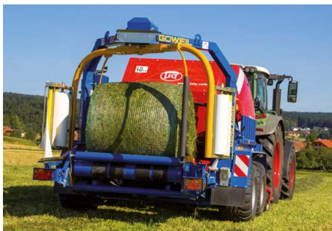
Balík se předá z lisu na pojízdny ovíjecí stůl.
